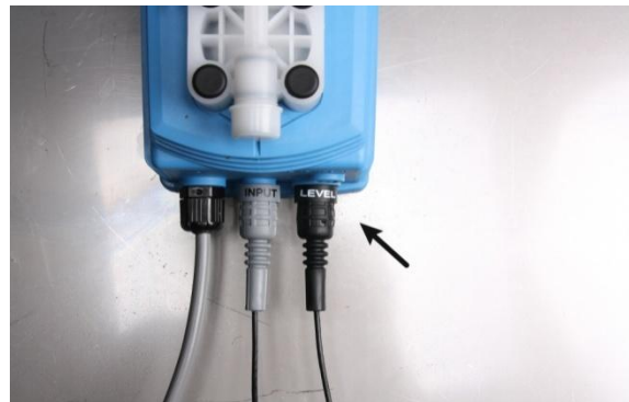
Imagen 2: Conexión de la protección contra el funcionamiento en seco y el contador de agua
