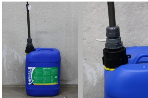
Figur 6: Forbind sugelansen med beholderen
