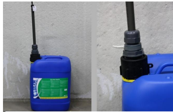
Imagen 6: Colocar lanza de aspiración sobre bidón
