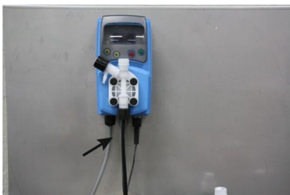
Imagen 3: Conectar tubo flexible aspiración
