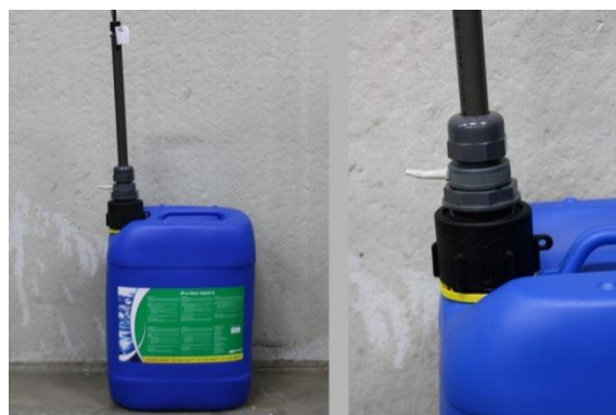
Afbeelding 6: Aanzuiglans op het vat plaatsen
