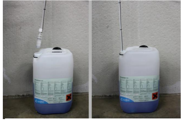
Figura 6: Mettere il tubo di aspirazione nel liquido.
