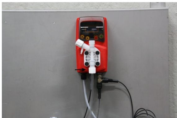
III. 3: Raccorder le tuyau d'arrivée
