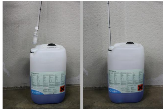
III. 6: Plonger tuyau d'arrivée dans le réservoir
