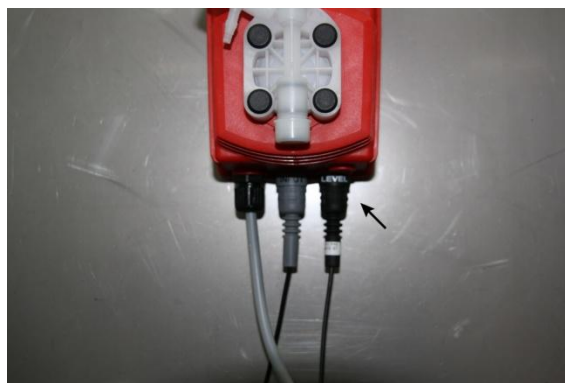
III. 2: Raccorder la sécurité anti assèchement
