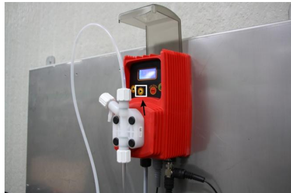
III. 8: Remplir la tubulure de sortie
