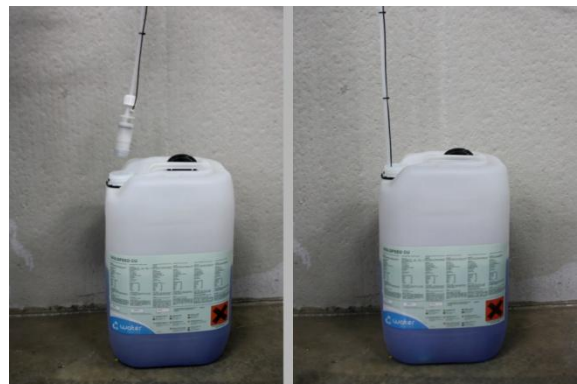
Afbeelding 6: Aanzuigslang in de vloeistof plaatsen
