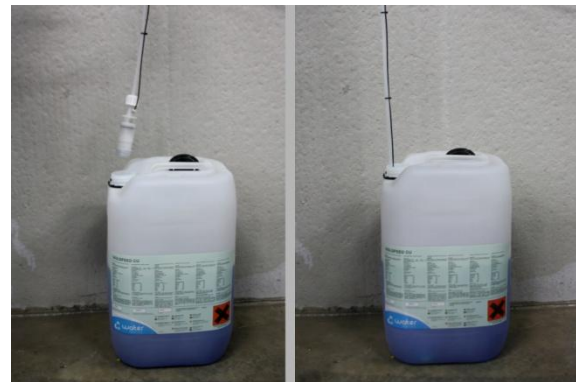
Abbildung 6: Saugschlauch in die Flüssigkeit hängen
