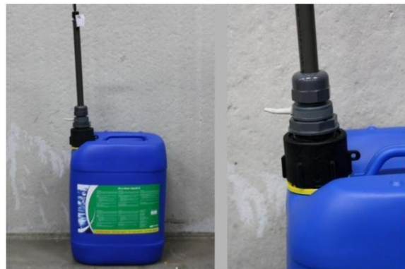
Figur 10: Forbind sugelansen med beholderen
