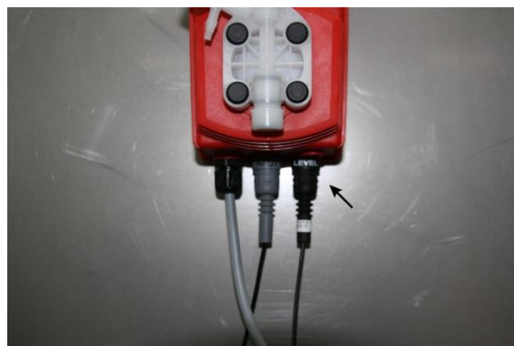
Imagen 6: Conectar protección funcionamiento seco
