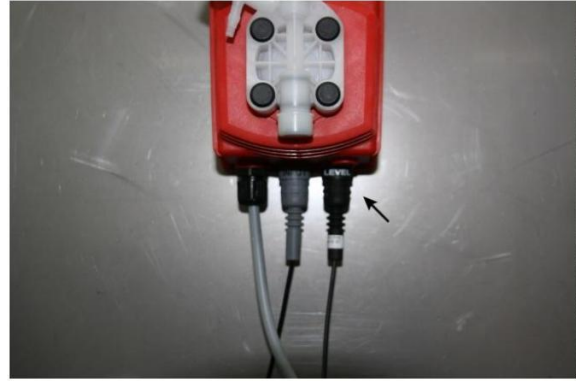
Ill. 6: Raccorder la sécurité anti assèchement
