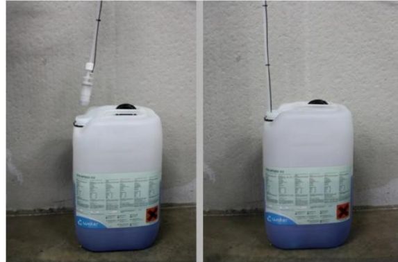
Ill. 13: placer lance d'arrivée dans le liquide
