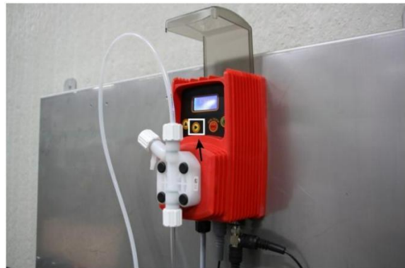
Ill. 15: Remplir la tubulure de sortie
