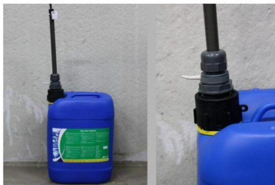
Ill. 10: Placer lance d'arrivée sur le réservoir
