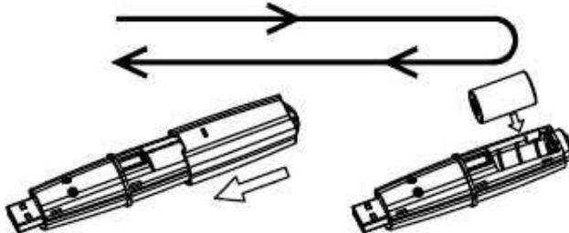
2. Introduzca la pila con el polo positivo en dirección hacia la interfaz USB.
