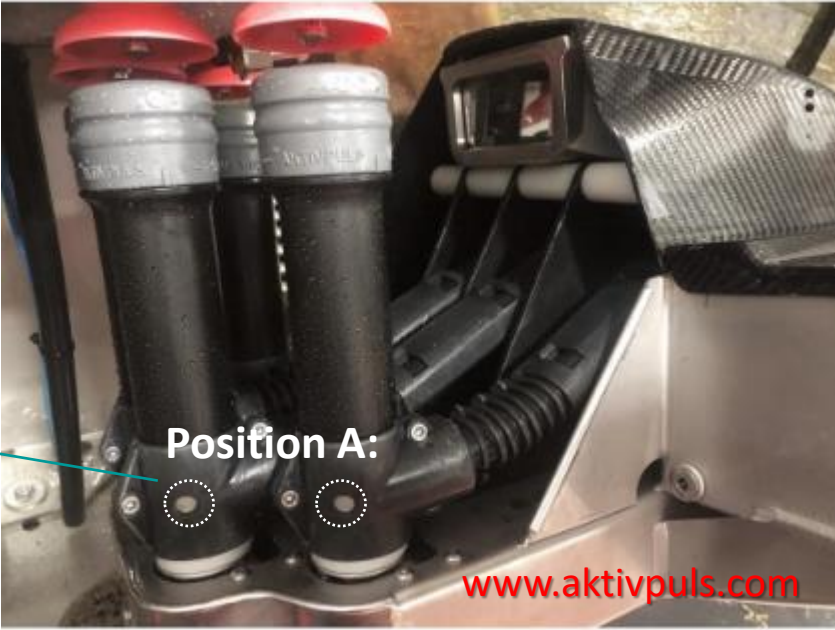
Composition LELY du set / ASSEMBLÉ: (4 x MANCHONS SILICONE / 4 x GOBELETS / 4 x JOINTS TORIQUES / 4 x BOUCHONS)
