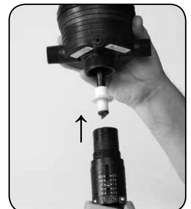
Passo 9. Enrosque o CILINDRO EXTERNO N°7 no corpo da unidade.
