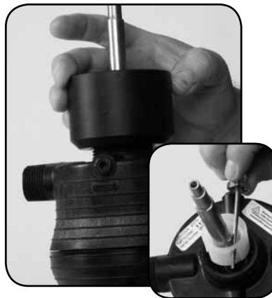
Paso 5. Retire el ADAPTADOR #72, así como el o-ring #68, el RETÉN DE LA JUNTA #15 y el SEPARADOR DE LA JUNTA DEL EJE #83. Reemplace si está dañado o gastado.
