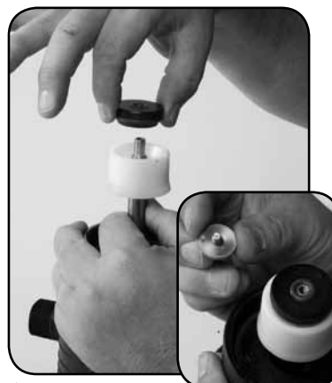
Étape 8. Remplacez le GUIDE DU PISTON DOSEUR n° 73 et le PISTON DOSEUR n° 44.
