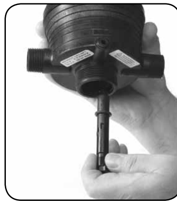
Passo 5. Substitua o O-ring N°17.
