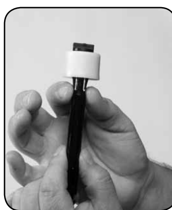
Paso 6. Presione las pestañas en el eje y retire el PISTÓN DOSIFICADOR #44.
