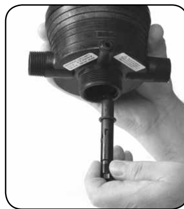
Étape 5. Remplacer le JOINT TORIQUE #17.
