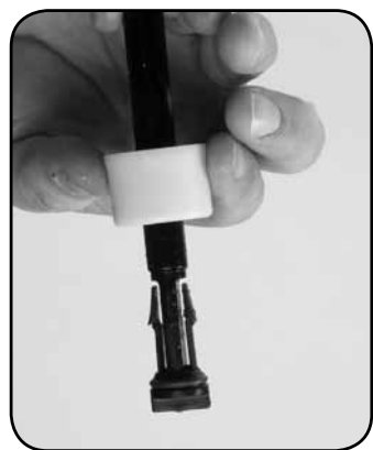
Paso 7. Reemplace el PISTÓN DOSIFICADOR #44 con las lengüetas delgadas hacia arriba.
