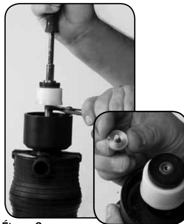
Étape 2. Twist pour déverrouiller et enlever la CAPSCREW #93.
