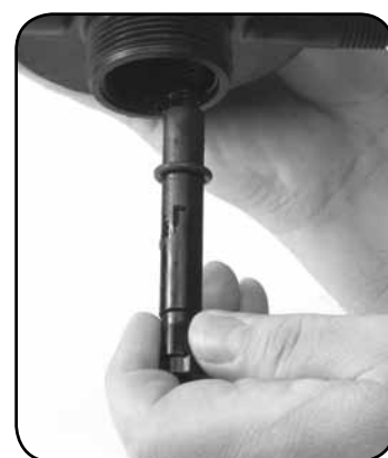
Paso 6. Reinserte del EJE INFERIOR N°52 y O-ring N°17.
