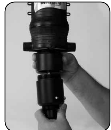
Paso 9. Enrosque el CILINDRO EXTERIOR n° 61 en el cuerpo.
