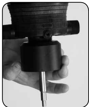
Passo 7. Coloque n° 68 o-ring e parafuso n° 72 adaptador sobre o corpo.
