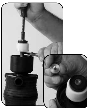
Schritt 2. Twist zu entsperren und entfernen Sie den CAPSCREW #93.
