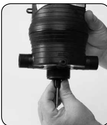
Passo 8. Substitua o CONJUNTO DO EIXO nº 51.
