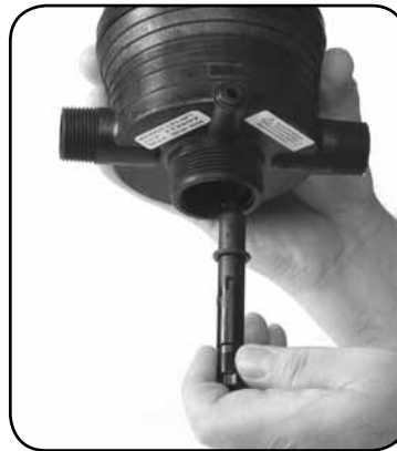
Schritt 5. Ersetzen Sie den O-ring #17.
