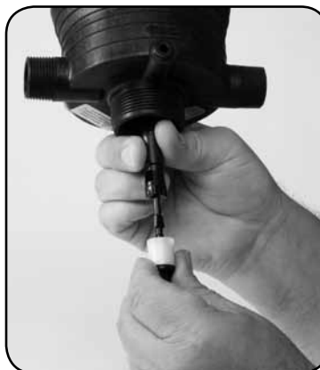
Paso 8. Reinstale el eje inferior con el nuevo pistón dosificador girando 90° para que quede en su lugar.
