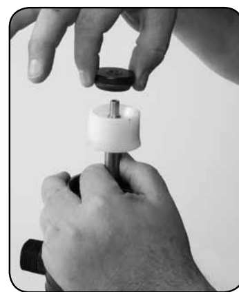
Passo 3. Remove o GUIA DO PISTÃO DOSADOR n° 73, limpe e inspecione o anel "O" n° 14.
