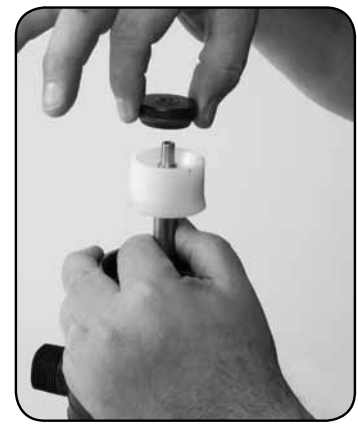
Paso 3. Retire la GUÍA DEL PISTÓN DOSIFICADOR #73, limpie y compruebe el o-ring #14.
