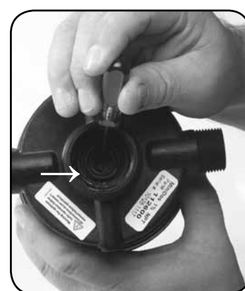
Passo 6. Substitua o anel em O no. 17.
