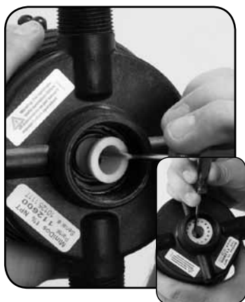
Étape 7. Remplacez la RONDELLE DE JOINTURE DE LA TIGE n° 82 et le joint n° 16.
