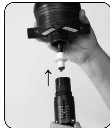
Paso 9. Enrosque el CILINDRO EXTERNO N°7 en el cuerpo de la unidad.
