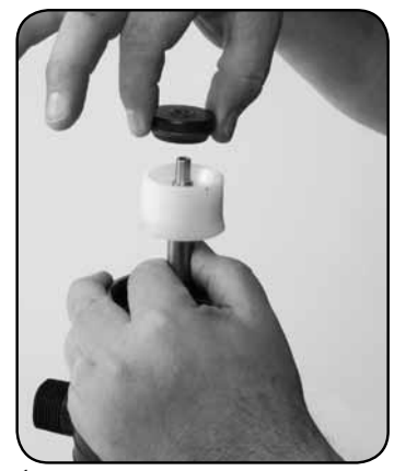
Étape 3. Retirez le GUIDE DU PISTON DOSEUR n° 73, nettoyez et inspectez le joint torique n° 14.
