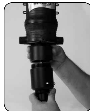
Schritt 9. Aparafuse o CILINDRO ESTERNO n° 61 no corpo.
