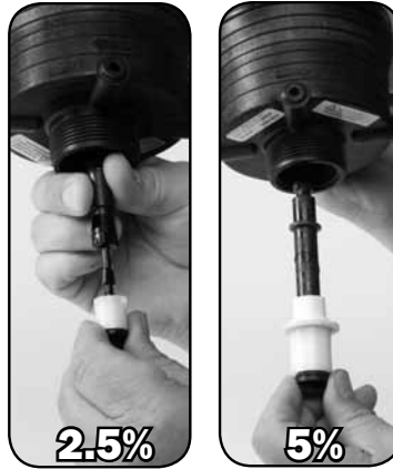
Passo 2. Gire o EIXO de 90° n° 51 ou n° 52 e remova.
