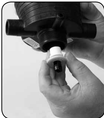
Paso 4. Extraiga del Limpie el asiento de las juntas N° 16 y N° 82.
