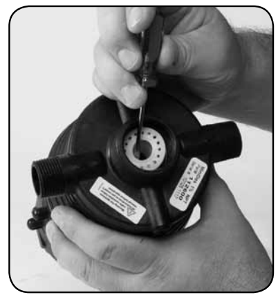
Schritt 3. Remove #16 Gasket.
