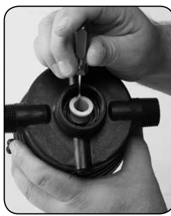
Passo 3. Remove o ESPAÇADOR DA VEDAÇÃO DO EIXO n° 83.
