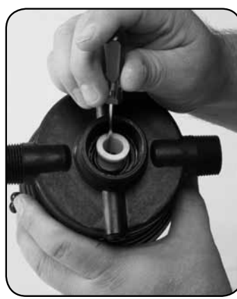
Paso 3. Retire el SEPARADOR DE LA JUNTA DEL EJE #83.
