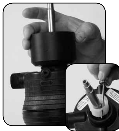
Étape 5. Twist et enlever l'ADAPTATEUR n° 72 ainsi que le joint torique n° 68, l'ARRÊTOIR DE JOINT n° 15 et la RONDELLE DE JOINTURE DE LA TIGE n° 83. Remplacez-les s'ils sont endommagés ou usagés.
