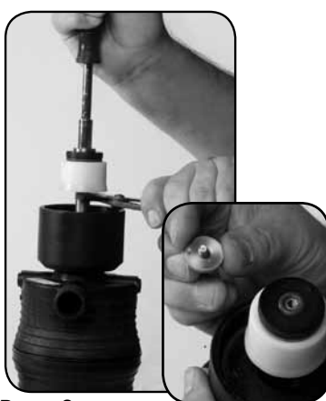
Passo 2. Torcer para desbloquear e CAPSCREW N°93.
