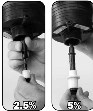
Schritt 2. Drehen Sie SCHAFT #51 oder #52 90° und entfernen Sie ihn.
