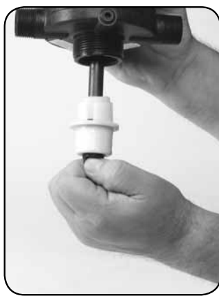
Passo 2. Torcer para desbloquear e EIXO N°52, JUNTA N° 16 e RESPONSÁVEL PELA RETENÇÃO N° 15.
