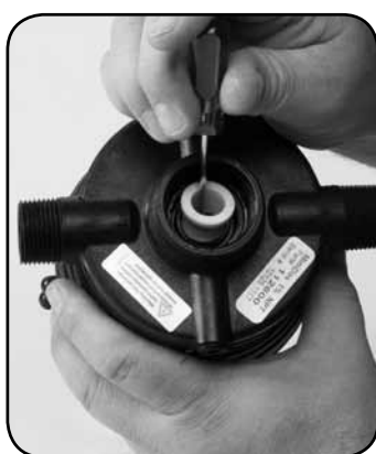
Passo 5. Substitua o ESPAÇADOR DA VEDAÇÃO DO EIXO n° 83.
