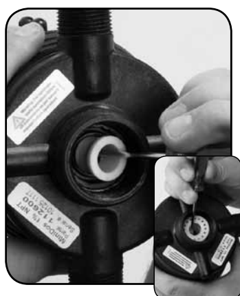
Passo 7. Substitua o ESPAÇADOR DA VEDAÇÃO DO EIXO nº 82.
