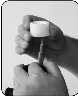
Paso 4. Retire el PISTÓN DOSIFICADOR #44.
