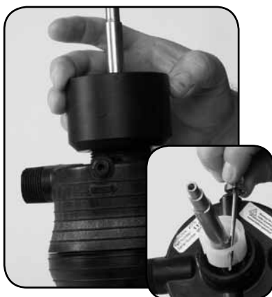
Passo 5. Remove o ADAPTADOR n° 72 bem como o anel "O" n° 68, o RETENTOR DA VEDAÇÃO n° 15 e o ESPAÇADOR DA VEDAÇÃO DO EIXO n° 83. Substitua se danificado ou gasto.
