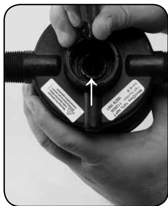
Paso 4. Retire el O-ring #17 y reemplace.
