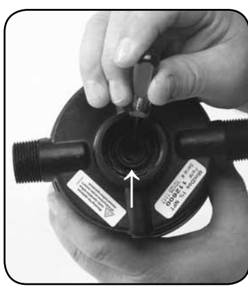
Paso 5. Extraiga el O-ring N° 17 y reemplace. Reemplace el O-ring N°17.
